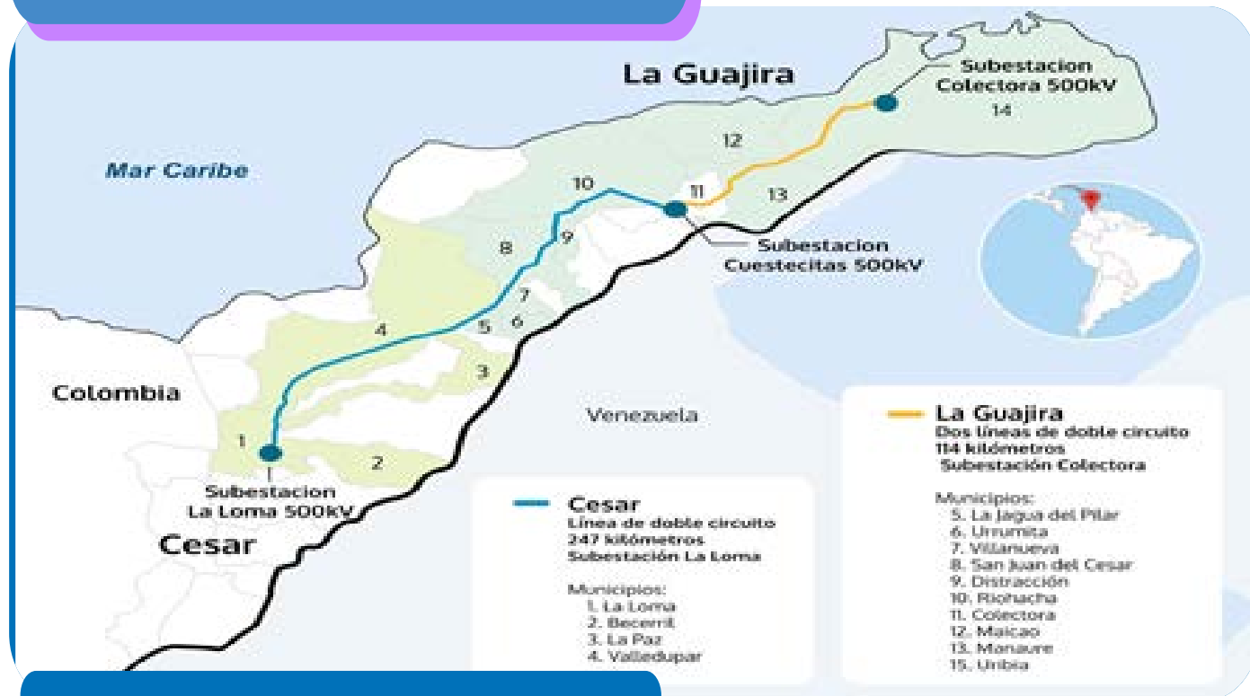
Figura 1: Dos Líneas de doble circuito de 114 kilómetros
